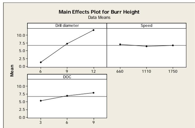
**Figure 3: Input parameters vs Burr Height**
